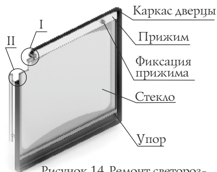
Рисунок 14. Ремонт светорозрачного экрана дверцы модели «Витра»
